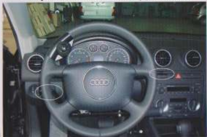
Freno y acelerador de leva doble y pomo al volante.
